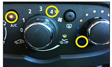
Ligue o ar condicionado no modo frio e posicione na potência máxima.
